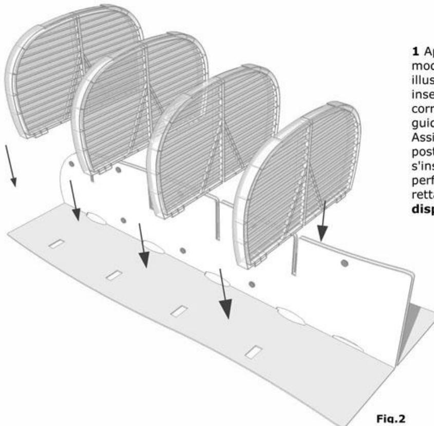
**1** Aprire il **Corpo Display** in modo che assuma la posizione illustrata nella *fig. 2* ed inserire i **vassoi** in corrispondenza dei 4 tagli guida. Assicurarsi che le asole posteriori dei vassoi s'inseriscano perfettamente nelle forature rettangolari del **corpo display**.
